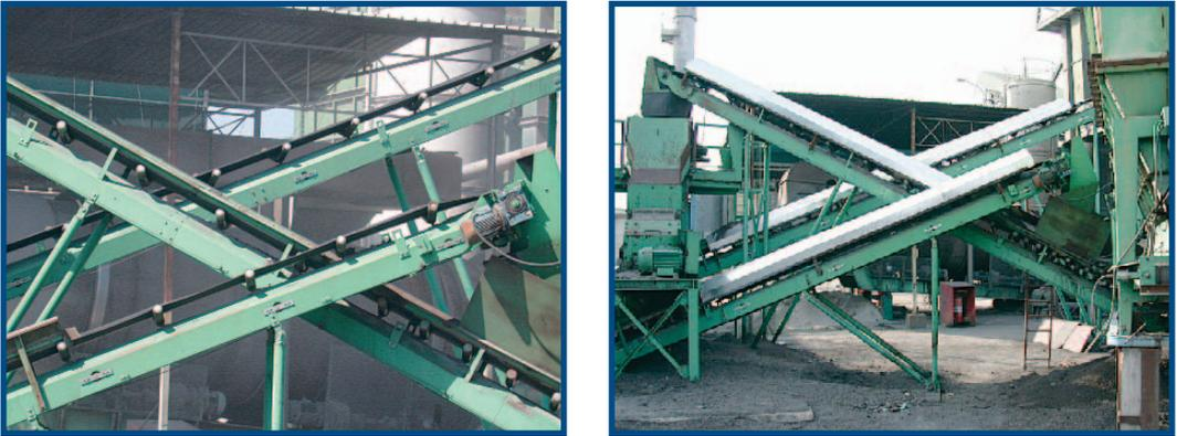
*Fig. 25 Zona trasporto inerti prima (a sinistra) e dopo (a destra) la realizzazione della copertura dei nastri trasportatori*
