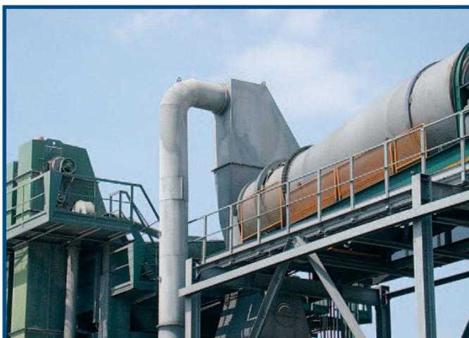
*Fig. 15* Produzione di conglomerati bituminosi. In alto: tramoggia di carico del conglomerato con attigua cabina comandi; in basso: impianto di mescolamento del bitume con gli inerti.
